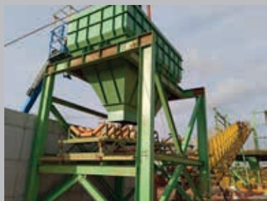
Moega de alimentação para peneiramento.
